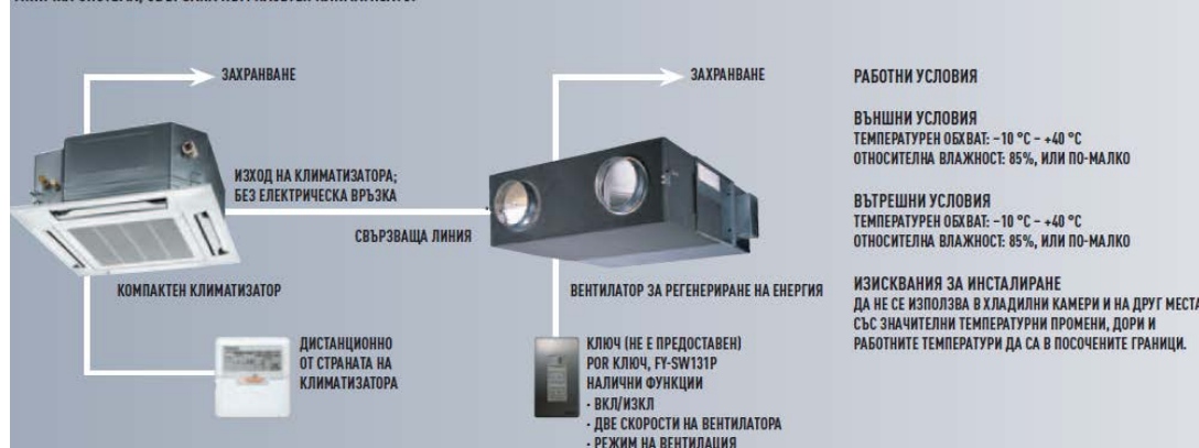
ТИПИЧНА СИСТЕМА, СВЪРЗАНА КЪМ КАСЕТЕН КЛИМАТИЗАТОР
