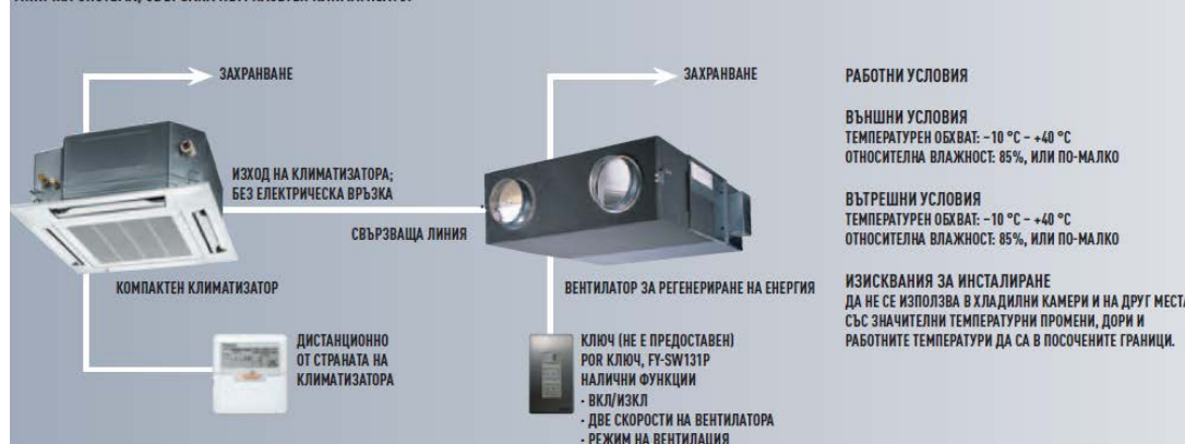
ТИПИЧНА СИСТЕМА, СВЪРЗАНА КЪМ КАСЕТЕН КЛИМАТИЗАТОР
