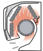
Този модел е снабден с функцията вътрешно изсушаване. След спиране на работа, натиснете бутона за вътрешно изсушаване на дистанционното управление, за да стартира процеса.
