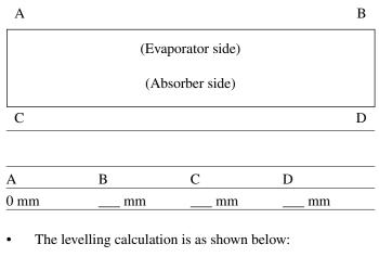
$\frac{A-B}{L} \quad \frac{C-D}{L} \quad \frac{A-D}{L} \quad \frac{B-C}{L} \quad \frac{A-C}{W} \quad \frac{B-D}{W}$
