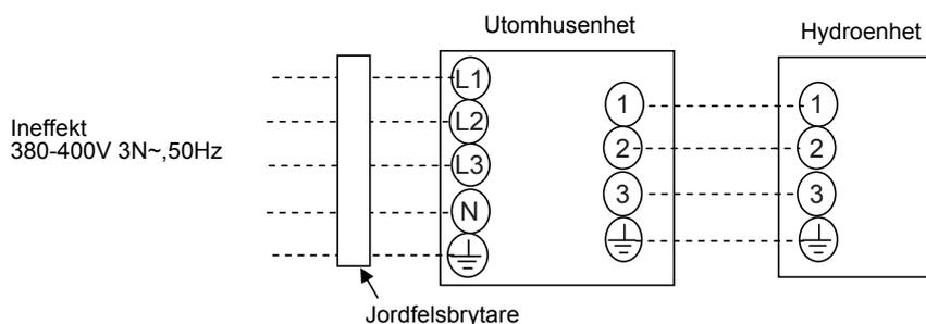
Använd en nätkabel med följande specifikationer för luft-till-vatten-värmepumpen.
