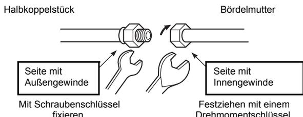
2. Arbeiten Sie, wie in der Abbildung dargestellt, beim Lösen oder Festziehen der gasseitigen Bördelmutter des Ventils mit zwei Schraubenschlüsseln. Wenn Sie nur einen Schlüssel verwenden, kann die Mutter nicht mit dem erforderlichen Drehmoment angezogen werden. Verwenden Sie aber für das Lösen oder Festziehen der Bördelmutter des Ventils auf der Flüssigkeitsseite nur einen Schraubenschlüssel.
