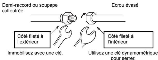
2. Comme illustré sur la figure, assurez-vous d'utiliser deux clés pour desserrer ou serrer l'écrou évasé de la soupape sur le côté gaz. Si vous utilisez une seule clé à molette, vous ne pouvez pas serrer l'écrou évasé au couple requis.
