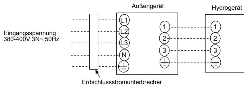
Schließen Sie an die Luft/Wasser-Wärmepumpe ein Netzkabel mit den folgenden Spezifikationen an.
